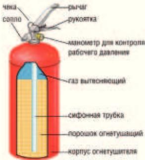
Устройство, заряженное огнетушащим порошком и закачанное газом (воздухом, азотом или углекислым газом). Порошковые огнетушители используют для тушения следующих классов пожаров:
