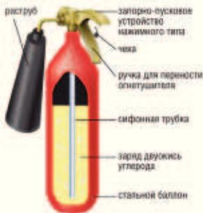
Устройство с зарядом двуокиси углерода (CO<sub>2</sub>) сжиженной, это позволяет снижать температуру и вытеснять кислород в месте возгорания.
